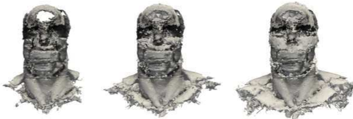
Рисунок 4 – Зоны высокой чувствительности для схемы измерения головы: а) порог 90%, б) порог 95%, в) порог 98%.
