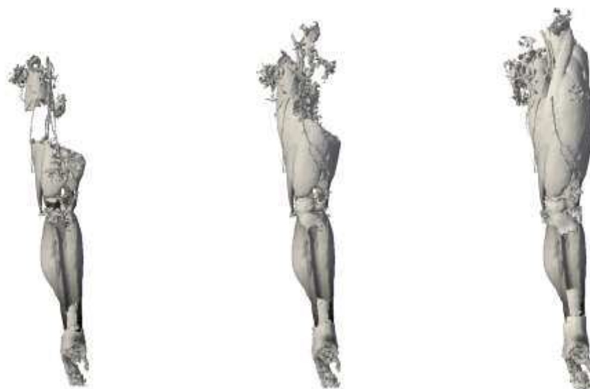
Рисунок 7 – Зоны высокой чувствительности для схемы измерения левой ноги: а) порог 90%, б) порог 95%, в) порог 98%.
