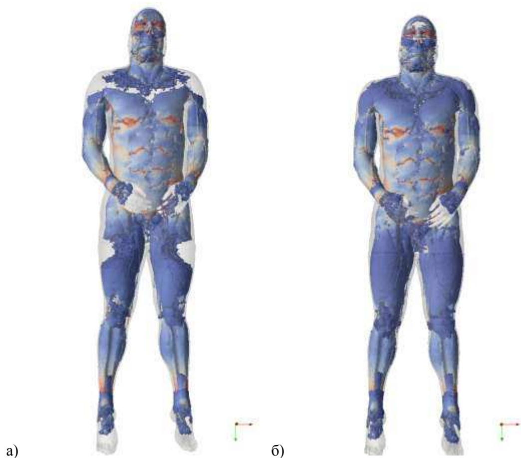
Рисунок 9 – Зоны высокой чувствительности для всех комбинаций схем измерения: а) порог 95%, б) порог 98%.
