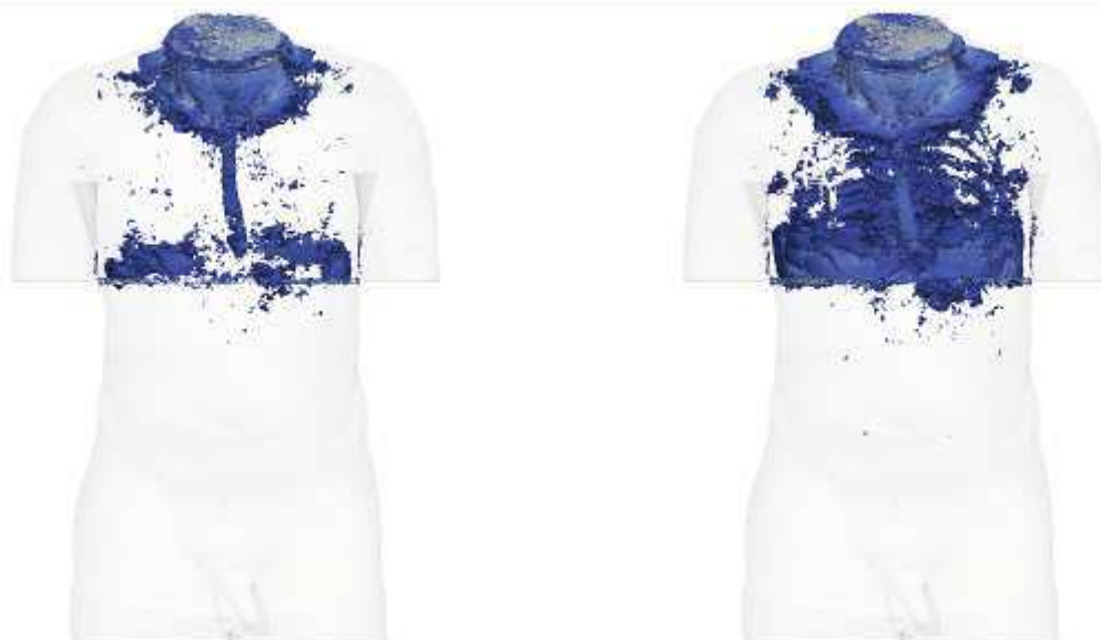
Рисунок 16 – Области высокой чувствительности, порог 50% и 70%. Частота измерений – 5кГц.
