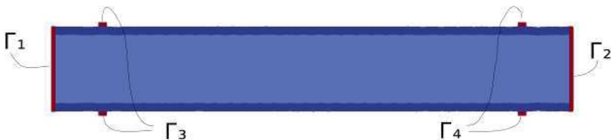
Рисунок 10 – Область \Omega и расположение контактных поверхностей электродов.
