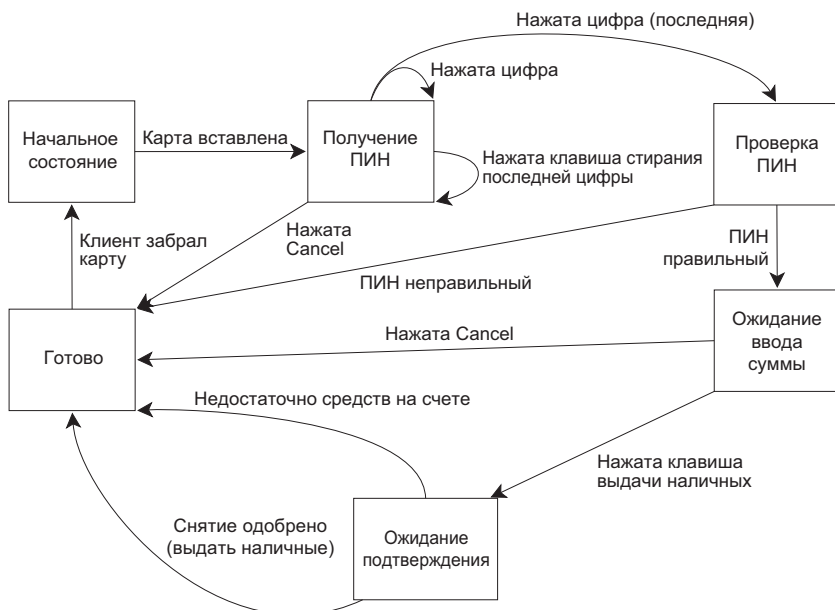
Рис. 4.3. Модель простого конечного автомата для банкомата
