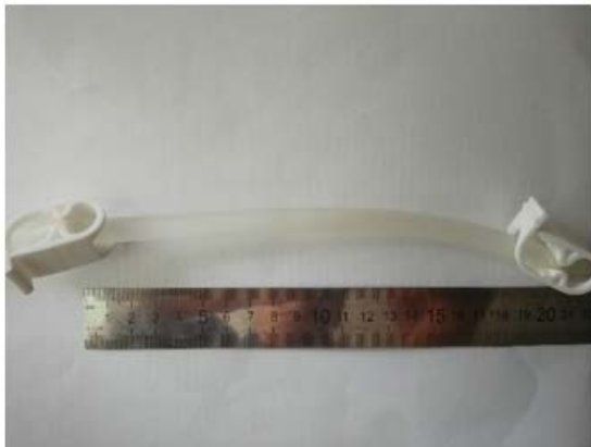
Рис. 5. Определение деформационных характеристик эластичного сосуда: a – образец эластичной трубки длиной 200 мм для механической поддержки кровообращения; b – измерение деформаций трубки с использованием тарированных гирь
