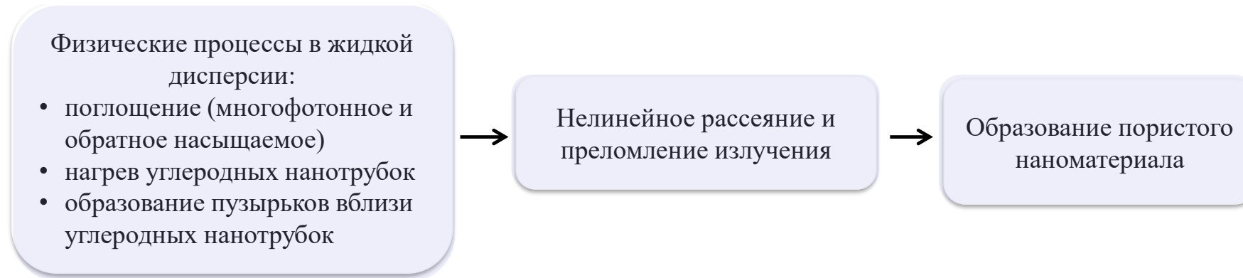
Рисунок 2 – Управление образованием пористого наноматериала с помощью контроля нелинейных характеристик взаимодействия импульсного лазерного излучения со средой
