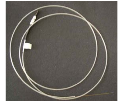
кварцевое оптоволокно диаметром 0,6 мм
