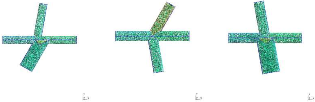
Рис. 3.2: Примеры расчетных сеток для областей стыковки четырех сосудов.
