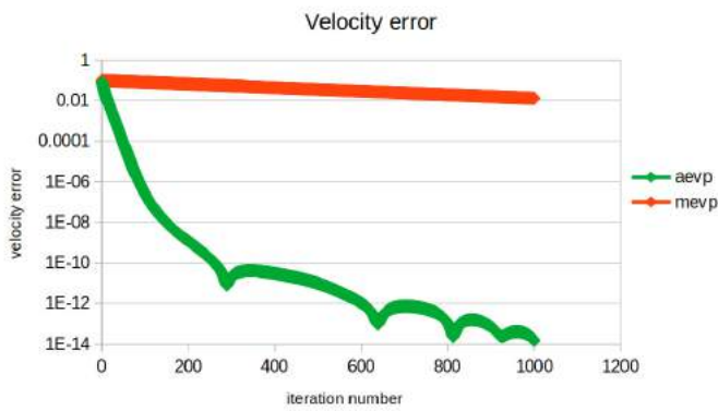
Рис. 4.5: Ошибка err_u для методов mEVP ( \alpha = \beta = 500 ) и aEVP в зависимости от номера итерации.
