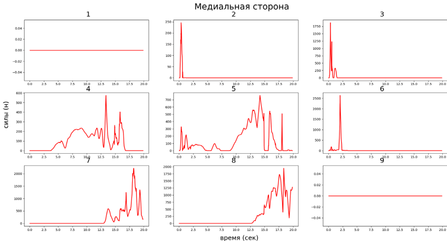
График 1: Контактные силы между большеберцовой костью и медиальным мышцелком бедренной кости
