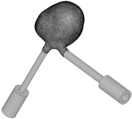
Рисунок 1 – Геометрия модели аневризмы с толщиной стенки 0,5 мм
