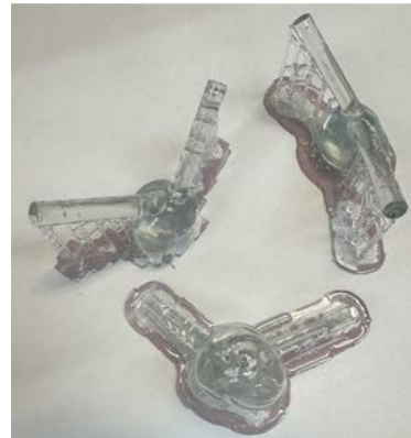
Рисунок 5 – Напечатанные методом LCD фантомы до отверждения в ультрафиолетовой камере
