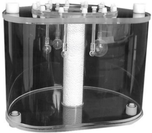
Рис. 1. Фантом NEMA IEC с шестью вставками диаметром 10, 13, 17, 22, 28 и 37 мм.
