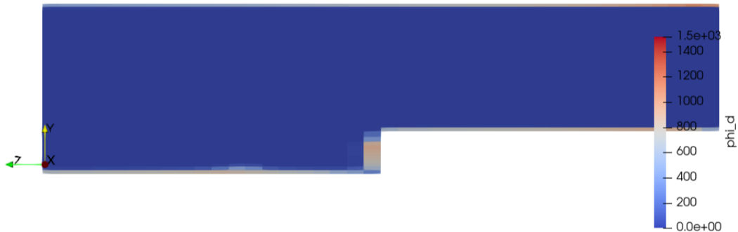
Рис. 5: Рост тромба в трубке со ступенькой через равные промежутки времени.
