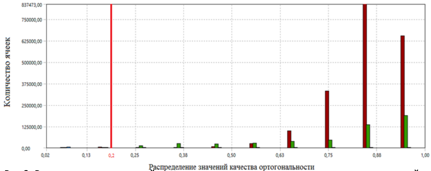
Рис.2. Распределение значений качества ортогональности по количеству ячеек во всей расчётной области насоса; красная линия – граница удовлетворительных результатов
