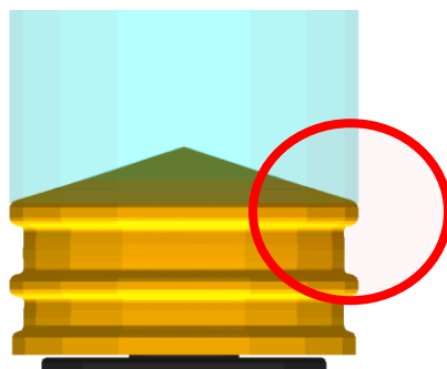
Неравномерные боковые нагрузки на поршень
