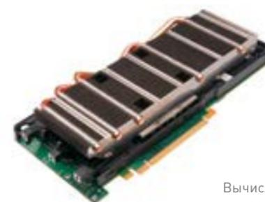
Вычислительные модули Tesla M2090 позволяют объединять в одном сервере или блейд-сервере графические и центральные процессоры.
