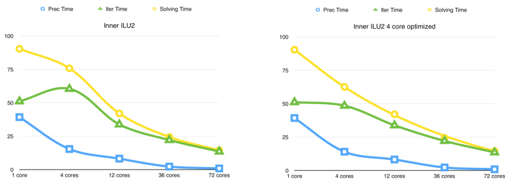
Рис. 6. Производительность (в сек.) линейного решателя Inner_ILU2 для задачи «tmt_unsym» при различных конфигурациях запуска на 4 ядра
